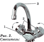
Рис. 2. Смеситель: 1 – корпус; 2 – вентильная головка; 3 – водоналивная трубка
