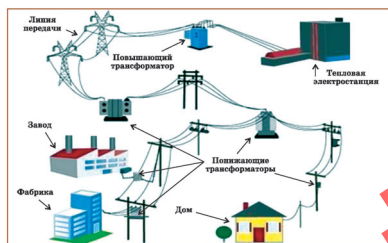
Рис. 1. Схема передачи и распределения электрической энергии
