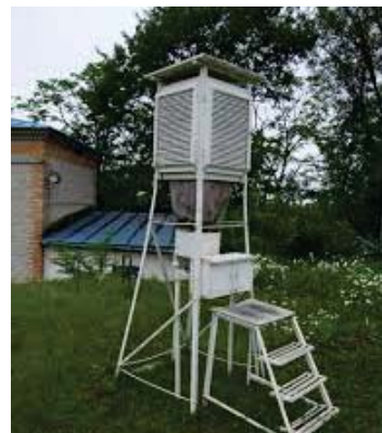
Havanın temperaturunun ölçülməsi üçün istifadə edilən qurğu
