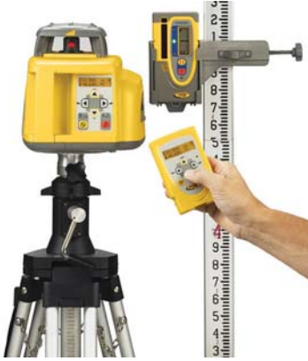
Nivelir – ərazidə relyef formalarının plana alınması üçün istifadə olunur
