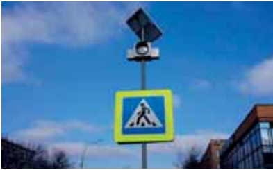
Günəş batareyası ilə işləyən piyada yol nişanı. Batareyalar gündüz saatlarında günəş enerjisini toplayaraq qaranlıq vaxtda ondan istifadə edir.
