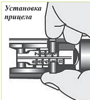
Постановка предохранителя на требуемый вид огня
