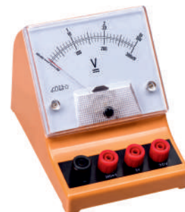
Voltmetr: gərginliyi ölçən cihaz – qövsvari şkala
