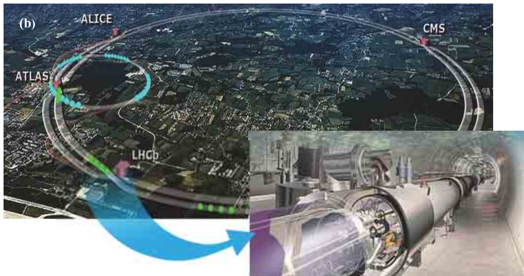
(b) - Схема “Большого адронного коллайдера” (БАК). Здесь ATLAS (A Toroidal LHC Apparatus), ALICE (A Large Ion Collider Experiment), LHCb (Large Hadron Collider Beauty Experiment) и CMS (Compact Muon Solenoid) – названия экспериментов, проведенных на установке БАК.
