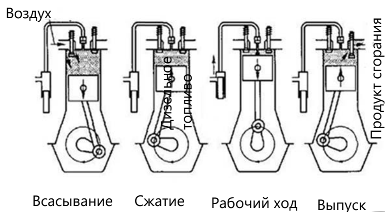
Рисунок 5. Принцип работы четырехтактного дизельного двигателя.
