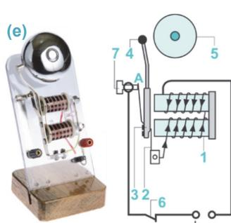
**Устройство и принцип работы электрического звонка.** Основные части электрического звонка следующие: электромагнит (1), упругая стальная пружина (2), подсоединенный к ней железный якорь (3), закрепленный на конце якоря маленький молоточек (4), являющийся источником звука металлическая чашка (5). При нажатии на
