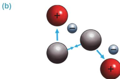
При этом процессе в газе возникают также отрицательные ионы: присоединив к себе свободные электроны, атомы нейтрального газа превращаются в отрицательные ионы (c). Так происходит **ионизация газа**. При помещении ионизированного газа во внешнее электрическое поле свободные электроны, положительные и отрицательные ионы приобретают упорядоченное движение и обеспечивают электропроводность газа.
