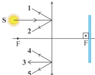
5. В какой линзе правильно показан дальнейший ход падающих параллельно главной оптической оси световых лучей после преломления их в линзе?
