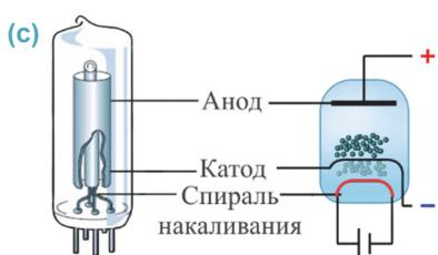
двухэлектродная вакуумная лампа в разрезе и ее условное обозначение на схемах (c).
