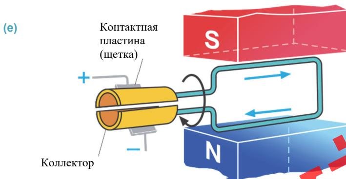
По поверхности полуколец скользят контактные пластины, называемые *щетками*. Щетки подсоединяются к разным полюсам источника тока и обеспечивают прохождение тока через рамку. При повороте рамки на  $180^\circ$  полукольца меняются местами. В результате меняется направление тока в рамке, и она продолжает вращательное движение в том же направлении до прекращения тока в цепи.
