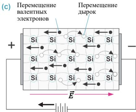
При соединении полупроводникового кристалла в электрическую цепь постоянного тока свободные валентные электроны совершают упорядоченное “движение” против направления вектора напряженности поля, а положительно заряженные дырки совершают упорядоченное “движение” в направлении вектора напряженности поля – возникает электрический ток (c). Так возникает собственная проводимость полупроводников.
