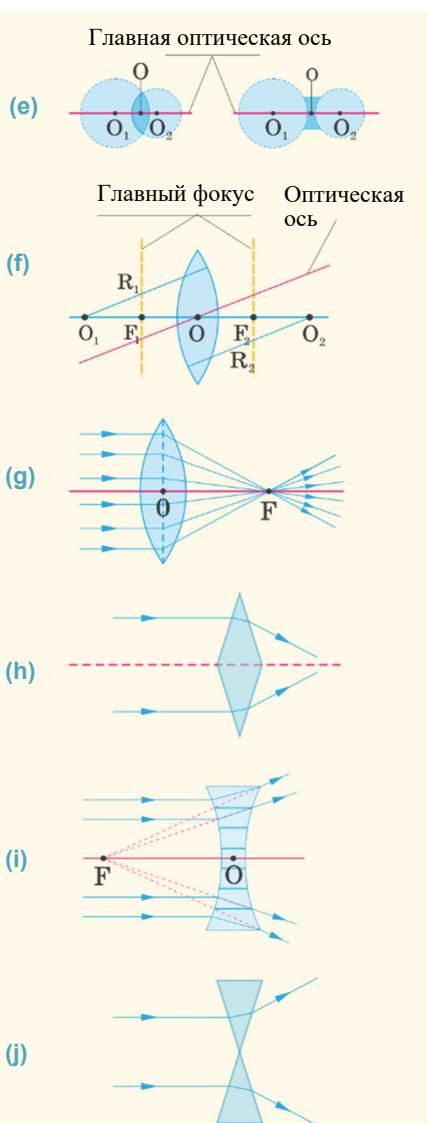
— Прямая линия, проходящая через центры  $O_1$  и  $O_2$  ограничивающих линзу сферических поверхностей, называется **главной оптической осью линзы**.
