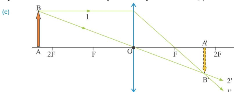
Здесь использованы два луча, выходящие из точки **В**: **1** – луч, падающий на линзу параллельно главной оптической оси, после преломления он проходит через главный фокус линзы (луч **1'**). **2** – луч проходит через оптический центр линзы, не испытывая преломления (луч **2'**). Пересечение этих двух преломленных лучей дает изображение **A'B'** тела **AB** (см.: **с**).
