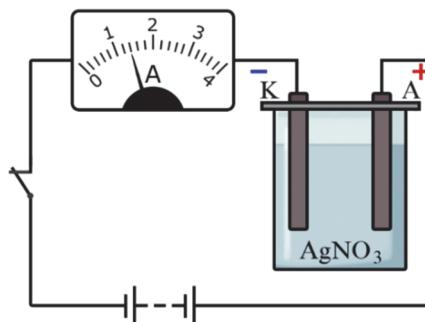
5. При протекании через раствор нитрата серебра электрического заряда 1 Кл на катоде выделилось 1,11 мг серебра. Сколько на катоде выделится серебра при прохождении через раствор 1500 Кл электрического заряда?
