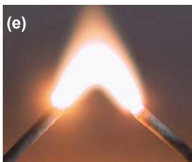
При этом разряде сила возникшего тока имеет очень большое числовое значение. Причиной электрической дуги является термоэлектронная эмиссия, происходящая с поверхности сильно нагревого катода. Дуговой разряд используется при электросварочных работах и в кинопроекторах.
