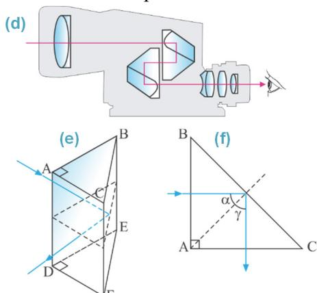
**Как происходит полное внутреннее отражение в призме?** Стеклянная призма помещается в оптическом приборе так, что луч света падает на ее поверхность перпендикулярно (е). Основание призмы – равнобедренный прямоугольный треугольник:  $(AB=AC; \angle BAC = 90^\circ)$ .
