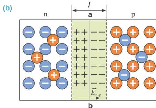
Электрическое поле ( $\vec{E}_{n-p}$ ), возникающее между зарядами двойного слоя, препятствует дальнейшему переходу электронов через границу соприкосновения кристаллов ab из n-части в p-часть, а дырок из p-части в n-часть. При подключении кристалла, имеющего p-n переход, в цепь постоянного тока, он будет хорошо проводить ток только в одном направлении. Это направление установить не трудно.
