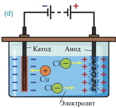
Электроды помещаются в электролитическую ванну, например, с водным раствором хлорида меди, и цепь замыкается. Возникшее электрическое поле создает направленное движение положительных ионов меди к катоду, а отрицательных двух ионов хлора к аноду.
