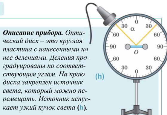
**Описание прибора.** Оптический диск – это круглая пластина с нанесенными на нее делениями. Деления проградуированы по соответствующим углам. На краю диска закреплен источник света, который можно перемещать. Источник испускает узкий пучок света (h).
