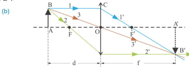
**Внимание!** Для упрощения схемы построения изображения достаточно использовать два любых луча, отмеченных выше. Отметим, что изображение крайней точки  $A$ , находящейся на главной оптической оси, получается также на главной оптической оси ( $A'$ ). Здесь  $d$  – расстояние от тела до линзы,  $f$  – расстояние от изображения до линзы (см.: b).
