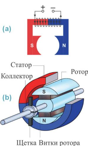
*Ротор* (от латинского слова *roto* – “вращаю”) – является подвижной частью двигателя, установленной внутри статора. Ротор состоит из электромагнита в форме цилиндрического сердечника. Его иногда называют *якорем*. С целью подачи в ротор электрического тока и обеспечения его непрерывного вращения используются коллекторы и щетки.
