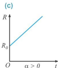
В результате число столкновений упорядоченно движущихся свободных электронов с ионами резко увеличивается, следовательно при нагревании сопротивление проводника увеличивается. В итоге сила тока в металлическом проводнике уменьшается. В интервале небольших температур сопротивление металлических проводников линейно зависит от температуры, и эта зависимость определяется следующей формулой (b):
