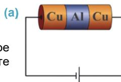
К цепи постоянного тока последовательно подключаются плотно прижатые друг к другу три металлических цилиндра одинакового размера. Крайние медные, а средний – алюминиевый (а). Через год непрерывного протекания электрического тока через эти цилиндры были исследованы их поверхности соприкосновения. Было выявлено, что, несмотря на длительное протекание электрического тока, не происходит переноса атомов меди в алюминий, а атомов алюминия в медь.
