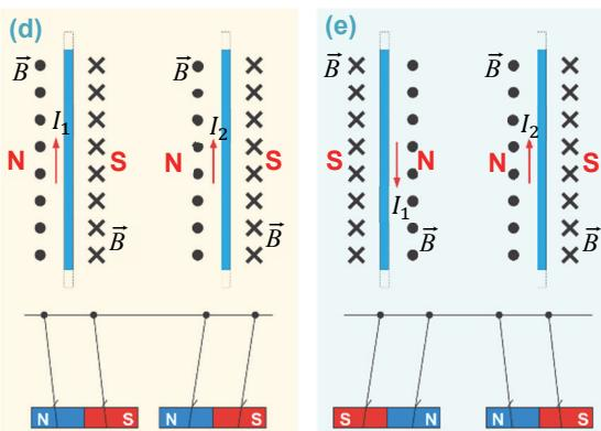
Взаимодействие между параллельными проводниками с током количественно характеризуется *силой магнитного взаимодействия*.
