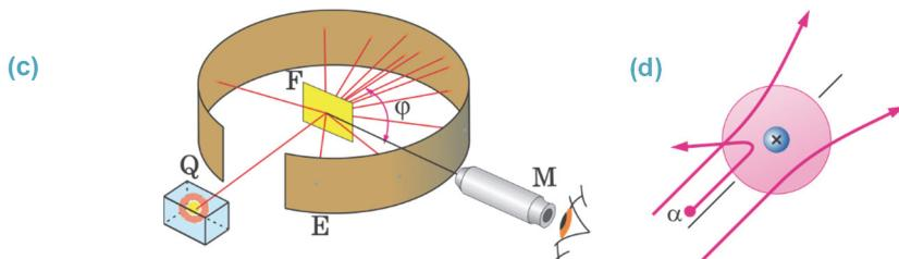
По результатам этого опыта была определена неверность атомной модели Томсона. По Резерфорду, большая часть массы атома и положительные заряды распределены не по всему объему атома, а сосредоточены в его центре. Между электронами и положительным зарядами существует пустота. Очень маленькую часть атома, где сконцентрированы положительные заряды атома, Резерфорд назвал *атомным ядром*. Таким образом, согласно модели Резерфорда, атом имеет следующее строение:
