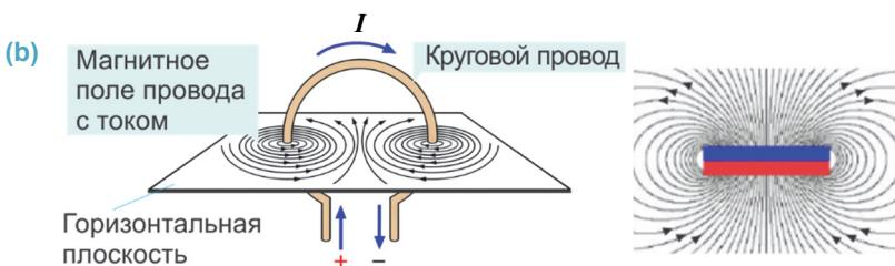
Направление магнитной индукции кругового тока определяется направлением тока, и его легко можно определить при помощи магнитной стрелки. А при отсутствии магнитной стрелки для этой цели можно использовать правило правой руки или правило буравчика (винта).
