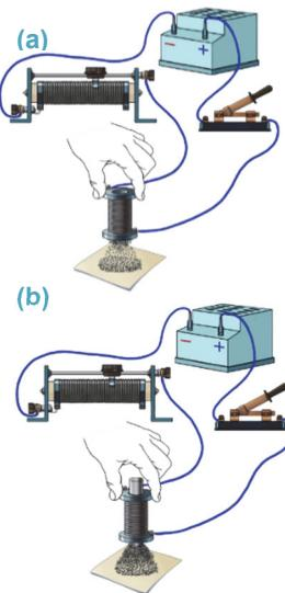
В 1820 году французский ученый А.Ампер, исследуя магнитное поле катушки с током, определил, что магнитное действие катушки зависит от силы тока в нем: с ростом силы тока растет магнитное действие катушки, а при отключении силы тока катушка теряет свои магнитные свойства. В 1825 году английский изобретатель В.Стерджен, введя внутрь катушки с током железный сердечник, выяснил, что магнитное действие катушки увеличилось.
