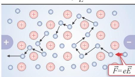
Итак, электрический ток в металлических проводниках – это результат упорядоченного движения свободных электронов, который не приводит к изменению химического состава металла.
