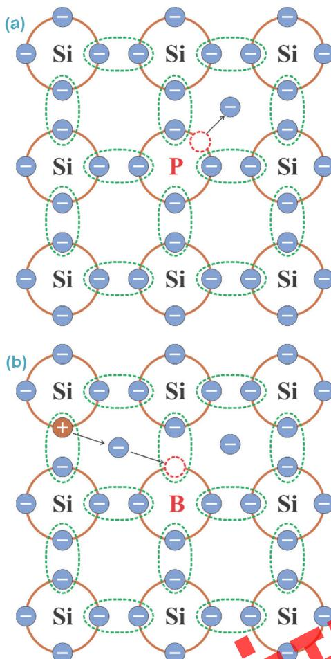
При добавлении примеси в чистый полупроводник в ничтожном количестве его проводимость резко возрастает.
