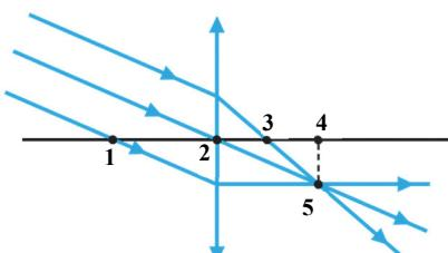
4. В фокусе тонкой линзы расположено плоское зеркало. Какой цифрой обозначен конечный ход луча света от источника света  $S$ , падающего на поверхность линзы параллельно главной оптической оси?
