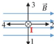
2. Прямой проводник с током длиной 2 м помещен в однородное магнитное поле с индукцией 60 мТл перпендикулярно линиям индукции. Вычислите силу Ампера, действующую на проводник, если сила тока в нем равна 2 А.
