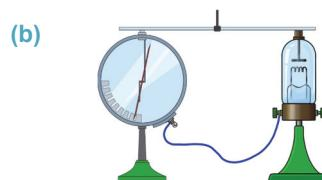
**Термоэлектронная эмиссия.** Электроны, находящиеся у поверхности металла, могут его покинуть, то есть “испаряться” как молекулы жидкости.
