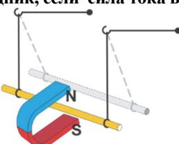
3. Определите направление тока в проводнике, смещающимся под действием магнитного поля.
