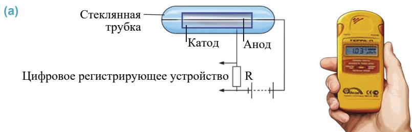
Между анодом и катодом создают высокое напряжение. Трубка заполняется неоном или аргоном, обладающими малым давлением. При попадании внутрь баллона заряженных частиц, входящих в состав радиоактивного излучения, они ионизируют находящийся там газ: электроны направляются к аноду, а положительные ионы к катоду. Сила тока, проходящая через счетчик, резко увеличивается и регистрируется цифровым устройством (см.: а).
