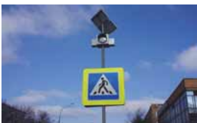
Знак пешеходного перехода, работающий на солнечных батареях.
