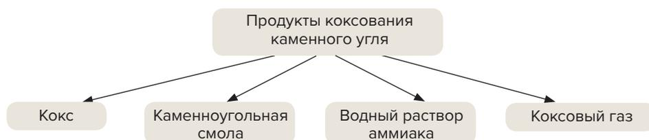
Коксование каменного угля осуществляется в коксовых печах. Коксовая печь – это металлическая камера, внутренние стены которой выстроены из огнеупорного материала. В печь загружают 20 тонн каменного угля и в течение 14-15 часов нагревают камеру. Из 1 тонны угля получают 750-800 кг кокса.
