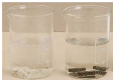
Kalsium parçaları Duru xlorid turşusu Dəmir parçaları Duru xlorid turşusu
