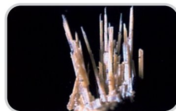
Rombik kükürd 96^\circ\text{C} -dən yuxarı temperaturda tədricən qızdırıldıqda onun kristal quruluşu dəyişir. Nəticədə molekullar fərqli şəkildə düzülərək iynə formalı monoklinik kükürd kristalları əmələ gətirir.
