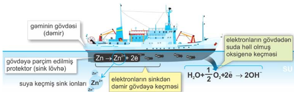
(d) Gəmi gövdəsinin protektor üsulu ilə mühafizəsinin sxemi
