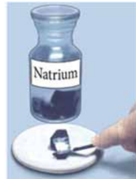
(a) Na metalının ağ neftdə saxlanması və lansetlə kəsilməsi
