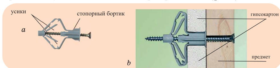
Рис.9 Закрепление предмета на гипсокартоне
