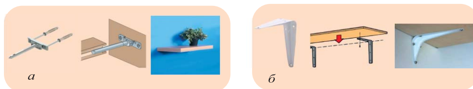
Рис. 1. Способы крепления с помощью специальных креплений: а – невидимый (внутренний штырь), б – видимый (кронштейн**)
