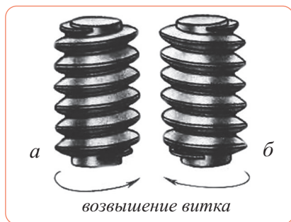
Рис. 4. Виды резьбы по направлению витка: а – правая резьба; б – левая резьба
