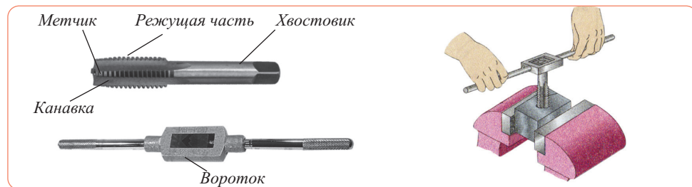
Рис. 7. Нарезание внутренней резьбы метчиком
