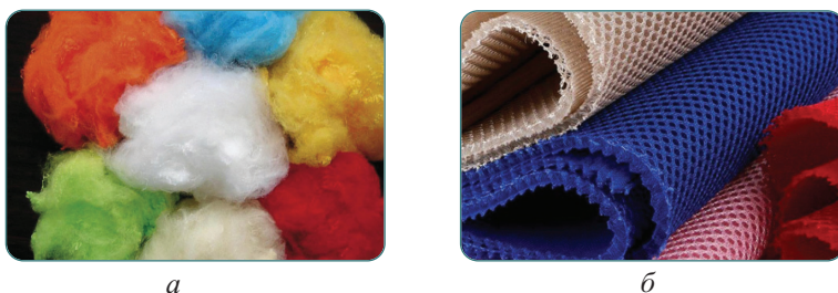
Рис. 3. а – полиэфирные волокна; б – ткани из полиэфирных волокон
