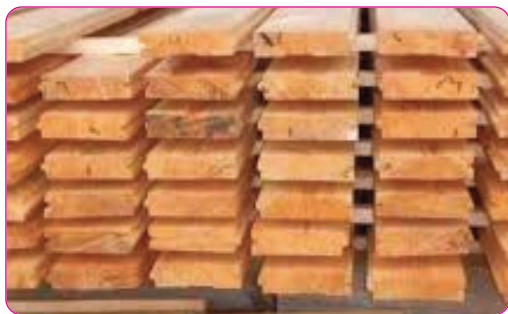
Рис. 1. Сушка пиломатериалов в штабелях
