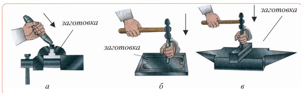
Рис. 4. Рубка металла: а – в тисках; б – на разметочной плите; в – на наковальне
