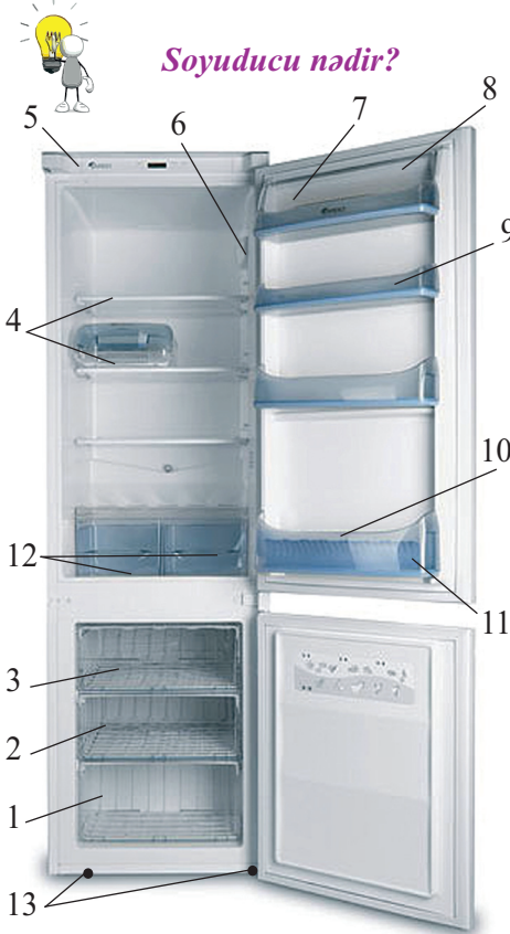
Şəkil 1. Məişət soyuducusu: 1 – dondurucu kamerasının tutumu; 2 – aralıq qutu; 3 – üst yeşik; 4 – soyuducu kamerasının rəfləri; 5 – temperatur tənzimləyicisi; 6 – soyuducunun işıqlandırma qurğusu; 7 – ağız qapaqlı saxlama qabı; 8 – çevrilən rəf; 9 – yumurta saxlama rəfi; 10 – rəfayırın; 11 – çəpərli rəf; 12 – meyvə və tərəvəz qabı; 13 – tənzimləyici dayaqlar
