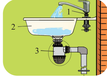
Şəkil 1. Əlüzyuyanın quruluşu: 1 – suqarışdırıcı; 2 – çanaq; 3 – sifon
