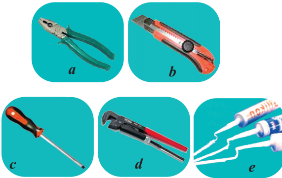
Şəkil 4. Sifonun quraşdırılması üçün alət və vasitələr
