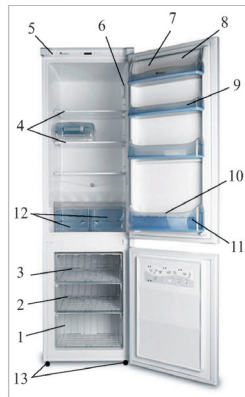
Şəkil 1. «Stinol-103» məişət soyuducusu: 1 – dondurucu kameranın tutumu; 2 – aralıq qutu; 3 – üst yəşik; 4 – soyuducu kameranın rəfləri; 5 – temperatur tənzimləyicisi; 6 – soyuducunun işıqlandırma qurğusu; 7 – ağzı qapaqlı saxlama qabı; 8 – çevrilən rəf; 9 – yumurta saxlama rəfi; 10 – rəf ayırıcı; 11 – çəpərli rəf; 12 – meyvə və tərəvəz qabı; 13 – tənzimləyici dayaq
