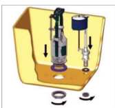
Şəkil 6. Axıdıcı baka yeni armaturun quraşdırılması
