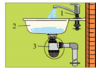
Şəkil 1. Əlüzyuyanın quruluşu: 1 – suqarışdırıcı; 2 – çanaq; 3 – sifon
