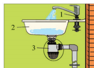
Şəkil 1. Əlüzyuyanın quruluşu: 1 – suqarışdırıcı; 2 – çanaq; 3 – sifon
