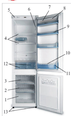
Şəkil 1. «Stinol-103» məişət soyuducusu: 1 – dondurucu kameranın tutumu; 2 – aralıq qutu; 3 – üst yəşik; 4 – soyuducu kameranın rəfləri; 5 – temperatur tənzimləyicisi; 6 – soyuducunun işıqlandırma qurğusu; 7 – ağzı qapaqlı saxlama qabı; 8 – çevrilən rəf; 9 – yumurta saxlama rəfi; 10 – rəf ayırıcı; 11 – çəpərlı rəf; 12 – meyvə və tərəvəz qabı; 13 – tənzimləyici dayaq
