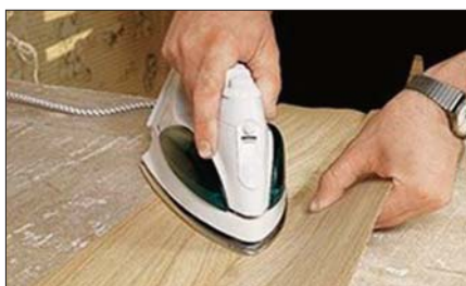
Şəkil 8. Ütü vasitəsilə şponun yapışdırılması
