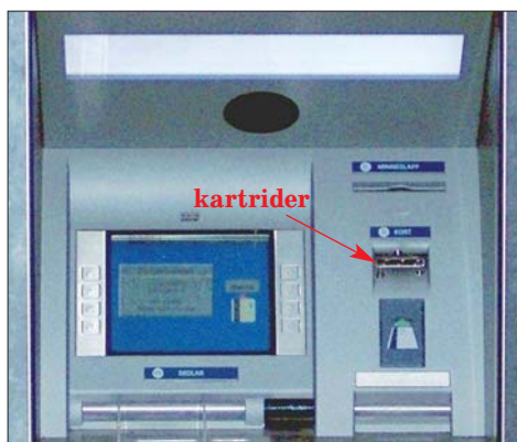
Şəkil 3. Bankomatın yuxarı ön hissəsi
