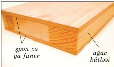
Şəkil 4. Xarrat lövhəsinin hissələri
