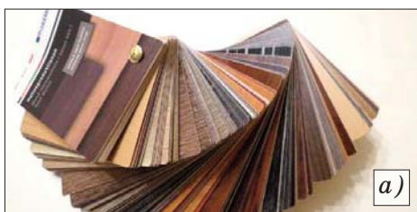
Şəkil 7. Üzləmə materialları: a) kağız təbəqə; b) kağız mebel lenti
