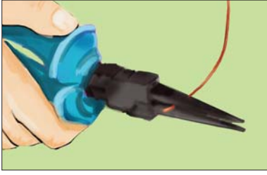
Şəkil 8. Məftilin ucunun sıxılması
