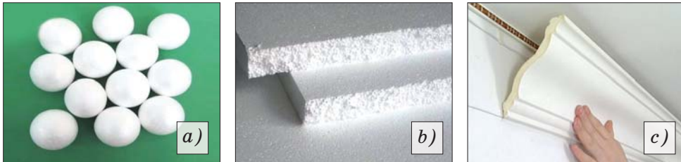
Şəkil 4. a) polistirol; b) polistirol təbəqəsi; c) polistirol karniz
