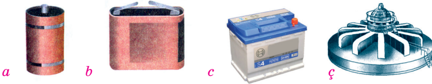
Şək. 1. Elektrik enerjisi mənbələri: a – qalvanik element; b – qalvanik elementlər batareyası; c – akkumulyator; d – elektrik generatoru
