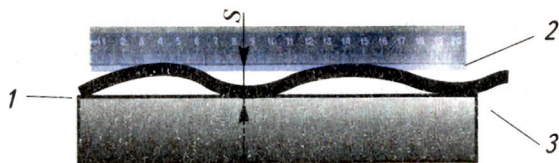
Şək. 3. Düzəldilmənin keyfiyyətinin yoxlanılması: 1 – məftil; 2 – xətkəşin tili; 3 – düzəltmə lövhəsi
