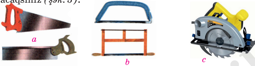
Şək. 2. Mişarların növləri: a – bıçqılar; b – yaylı mişarlar; c – diskli elektrik mişarı
